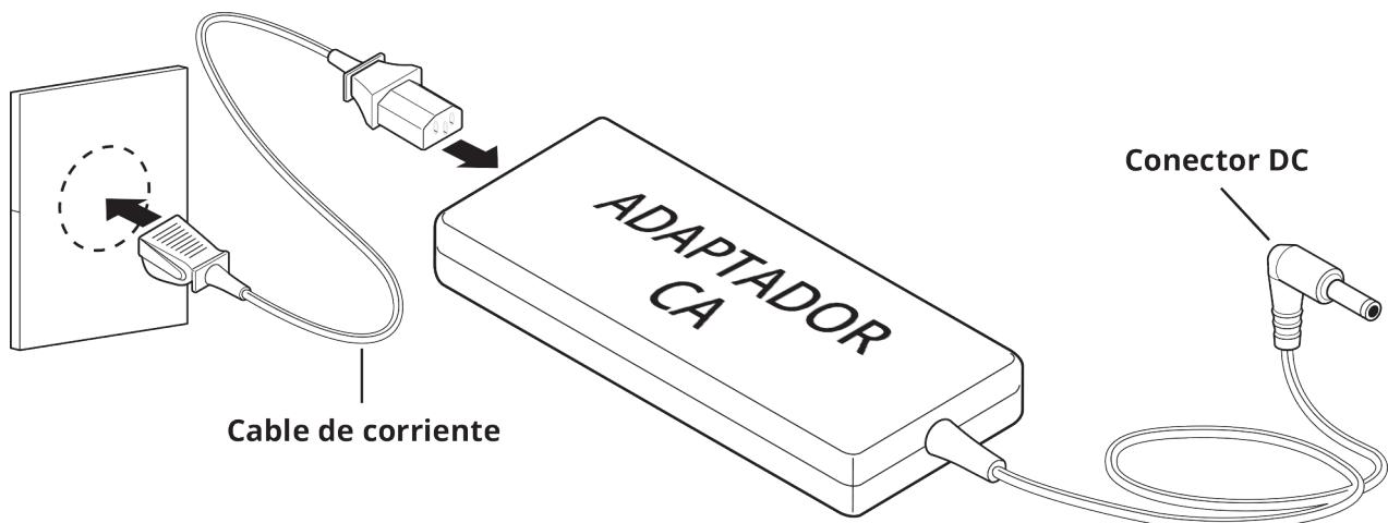
Conecte el enchufe de salida de CC del adaptador de CA al conector DC IN en el lateral izquierdo del equipo.
