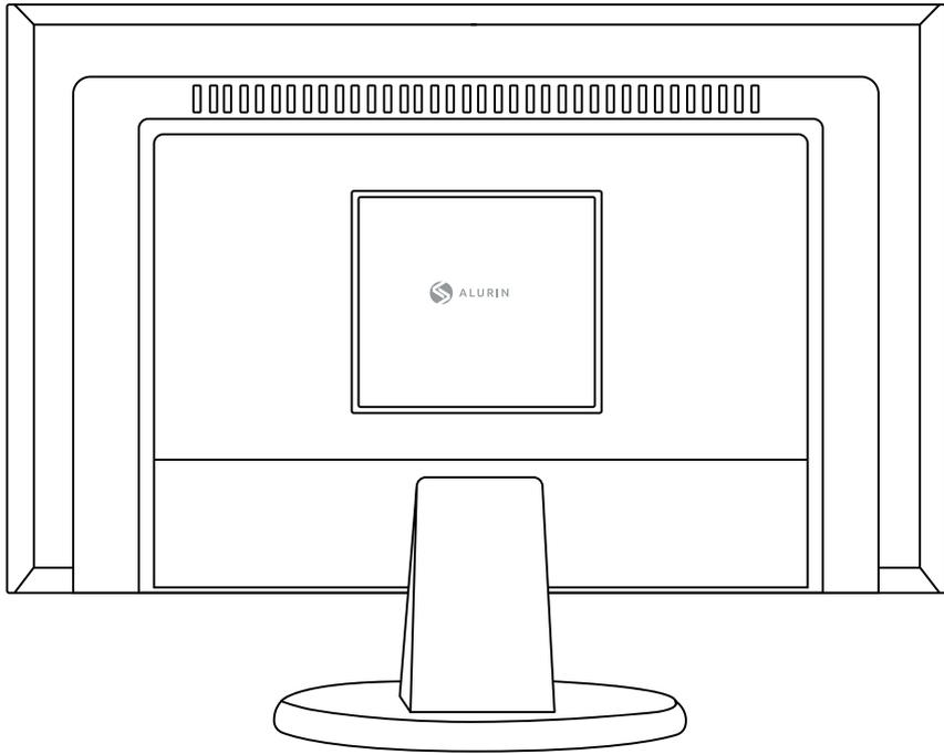
Para montar el mini Pc en la pantalla, coloque los 4 tornillos en el mini Pc y a continuación cuélguelo de la parte trasera de la pantalla.
